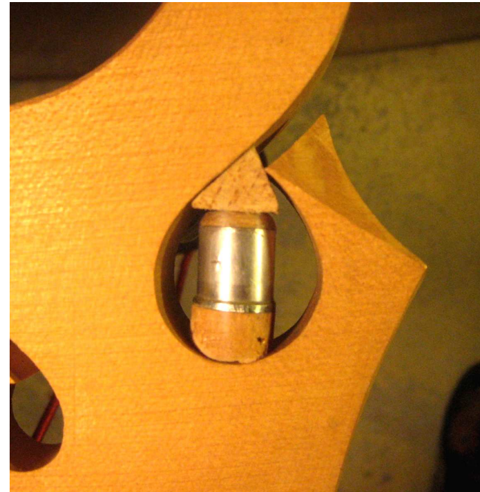
10) Vue du capteur monté sur une cale provisoire (non collée).
